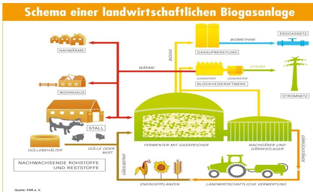
Abb. 4.3.1: Schema Biogasanlage (Quelle: www.nachwachsenderohstoffe.de)
