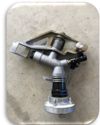
Abbildung 1 Detailaufnahme eines Kreisregnerkopfes (Quelle: Barth)
