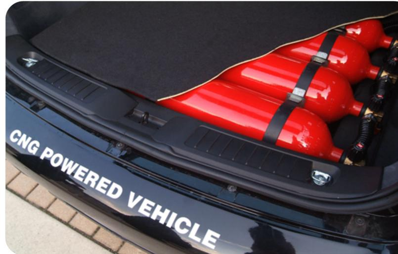
Abb. 1: Druckgasbehälter für CNG-Antrieb
