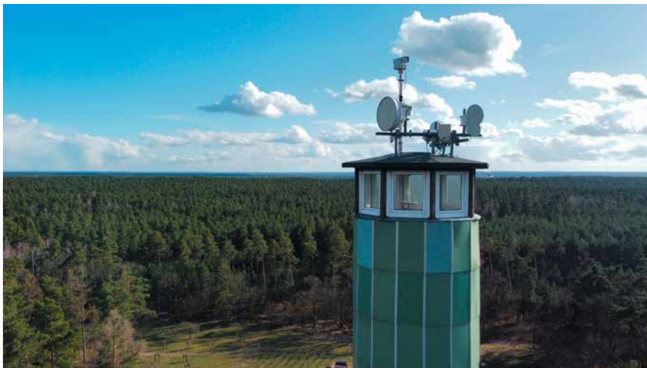
Abbildung 10: Auf einem Turm montierter Sensor zur automatisierten Waldbrandfrüherkennung. (Quelle: LFB)
